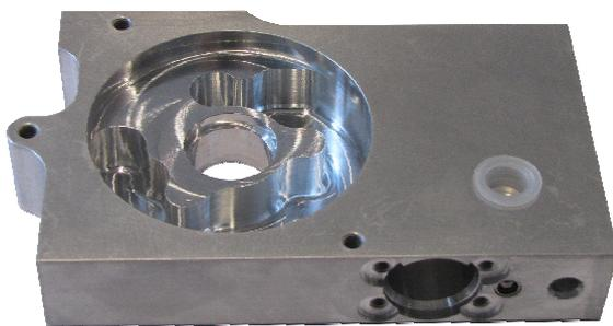
Diamètre  $\phi 18,5$ mm à vérifier
