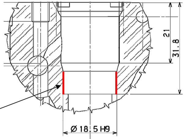
Si le diamètre mesuré est inférieur à 18,5mm, ou s'il n'est pas possible de positionner correctement le corps du clapet anti-retour, merci de nous faire parvenir le bloc HP en question à l'adresse indiquée ci-dessous, accompagné de cette « Infotech n°06-11 » et un échange sera effectué par la Boutique Citroën Racing.
